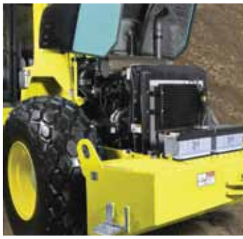
Implantation du moteur et de la batterie accessible
